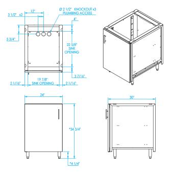
\* HEIGHT ADJUSTABLE +/- 3/4 in (19.05mm) RIGHT-HINGE MODEL SHOWN
