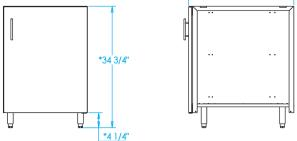
\* HEIGHT ADJUSTABLE +/- 3/4 in (19.05mm) RIGHT-HINGE MODEL SHOWN
