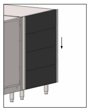
INSTALL THE BACK FINISHING PANELS
